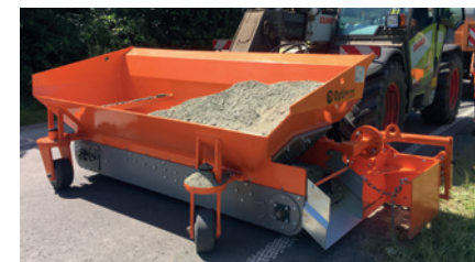
Bankettpflege (Schaufel 1,4 m³ mit Linksauswurf)
