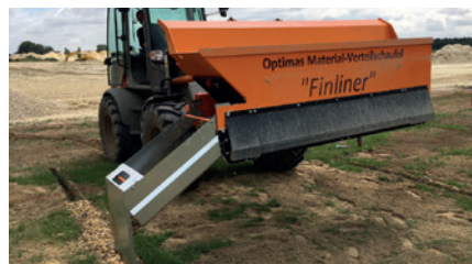
Verfüllen von Drainagegräben (Schaufel 1,0 m³ mit Rutsche lang und Materialleitblech)
