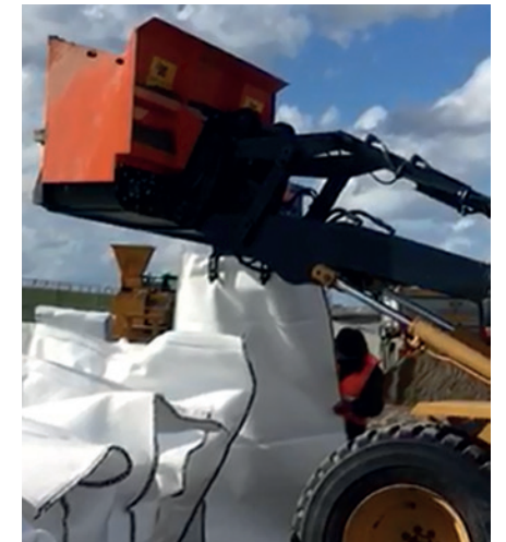
Befüllen von Big Bags (Schaufel 1,0 m³)
