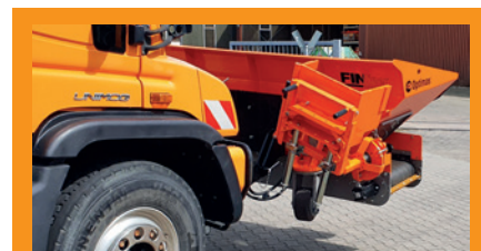
NEU! Das Bankettschild für die 1,4 m³ Schaufel wird für die Fahrt zum Einsatzort einfach hochgeklappt. Dadurch verringert sich die Gesamtbreite des Anbaugerätes und das Einsatzfahrzeug bleibt somit straßenverkehrstauglich.
